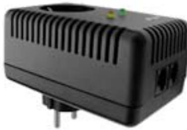
Sie schützen gleichzeitig die Stromversorgung und den Dateneingang der Kommunikationsgeräte. Durch einfaches Einstecken in die Steckdose sind die Geräte zur Selbstmontage zugelassen und der Fachmann für die Installation entfällt. Über den Schutzkontakt der Steckdose kann die Überspannung auch von der Datenleitung gefahrlos an den Potentialausgleich und damit an die Erde abgegeben werden.
